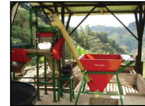
Separador hidráulico de tolva y tornillo sinfín
