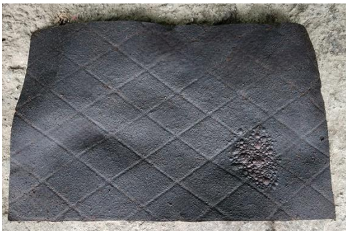
Cuero a base de pulpa de café sometido a calor
